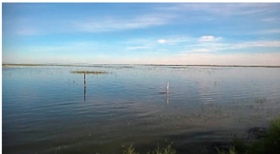
Фото 2.8. Рейки для мониторинга уровня воды в озере Рыбачье, июнь 2017 г. (фото: В. Соколова)
